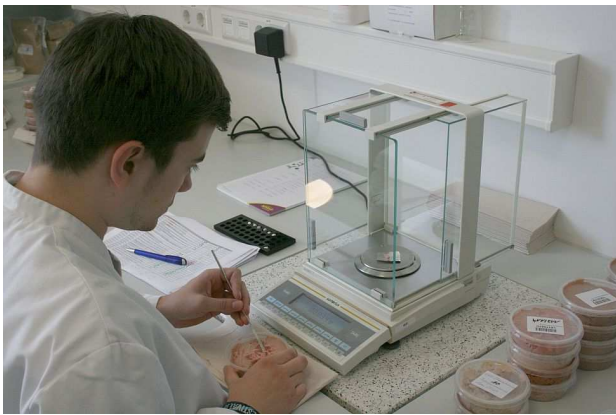
Einwiegen von Wurstproben für die Analyse
